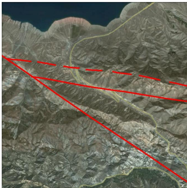
Рис. 1. Космоснимок с уточненным расположением Таласо-Ферганского разлома и «Линии Николаева» в районе Токтогульского водохранилища (пунктирной линией показано расположение «Линии Николаева» по геологическим данным).
