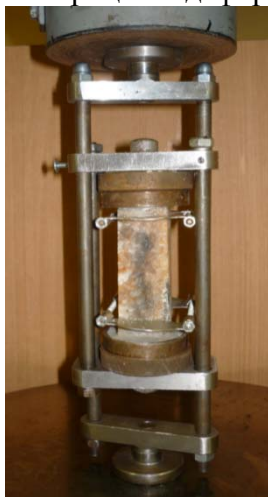
Рис.1. Испытательное реверсивное устройство с подготовленным образцом
