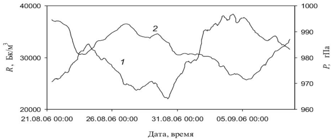
Рис.4. Вариация скользящего среднего значения R (1) (вычисления по 24 последовательным измерениям с компенсацией сдвига) в районе Ногинской тектонической структуры (2 – изменение атмосферного давления в период проведения измерений).
