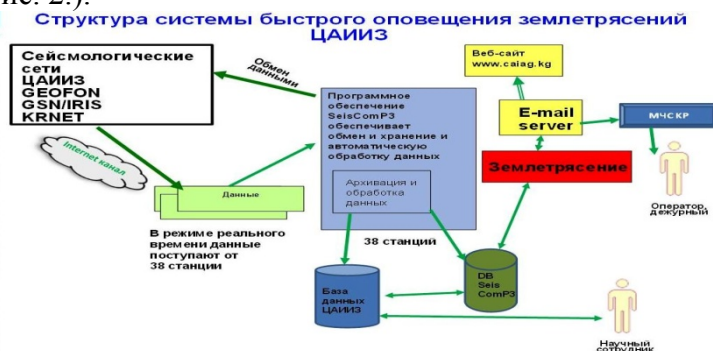
Рис.2. Структура системы оперативного оповещения ЦАИИЗ о землетрясениях
