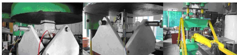
Рис. 1. Рычажная установка с установленными образцами для испытаний.
