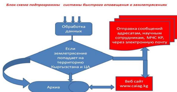
Рис.3. Блок схема подпрограммы системы оперативного оповещения.
