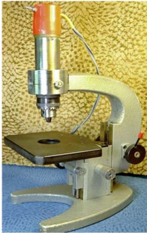
Рис. 1. Сверлильный станок на базе микроскопа.
