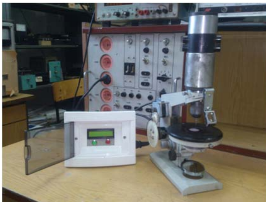
Рис. 9. Внешний вид станка и устройства управления.
