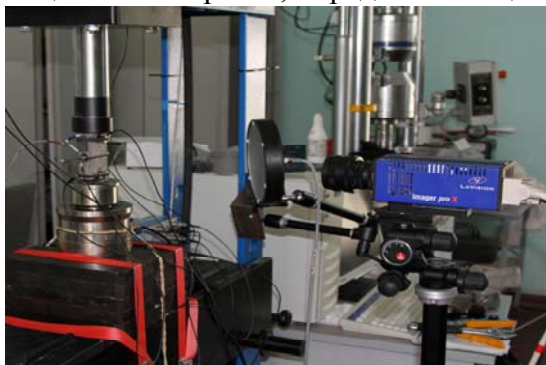
Рис. 1. Фотография эксперимента по исследованию деформации образца гранита (Каиндинское месторождение) при помощи системы LaVision Strain Master, укомплектованной одной камерой.
