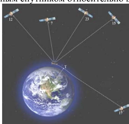
Рис. 2. Схема расположения спутников в эксперименте. ГСН-спутники 12, 7, 23,15 используются для позиционирования КА, спутник 17 используется для радиозатменных наблюдений.
