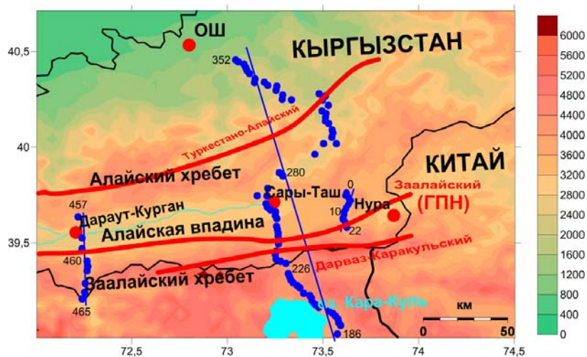
Рис. 1. Карта-схема расположения магнитотеллурических профилей «Дараут-Курган», «TIPAGE-ALAI» и «Нура», пересекающих Алайскую впадину. Синие кружки - пункты МТЗ-МВЗ; синие линии – профили МТЗ-МВЗ (с запада на восток: «Дараут-Курган», «TIPAGE», «Нура»); красные кружки – ближайшие населенные пункты; красные линии – основные разломы: ГПН – Главный Памирский надвиг (Заалайский разлом).
