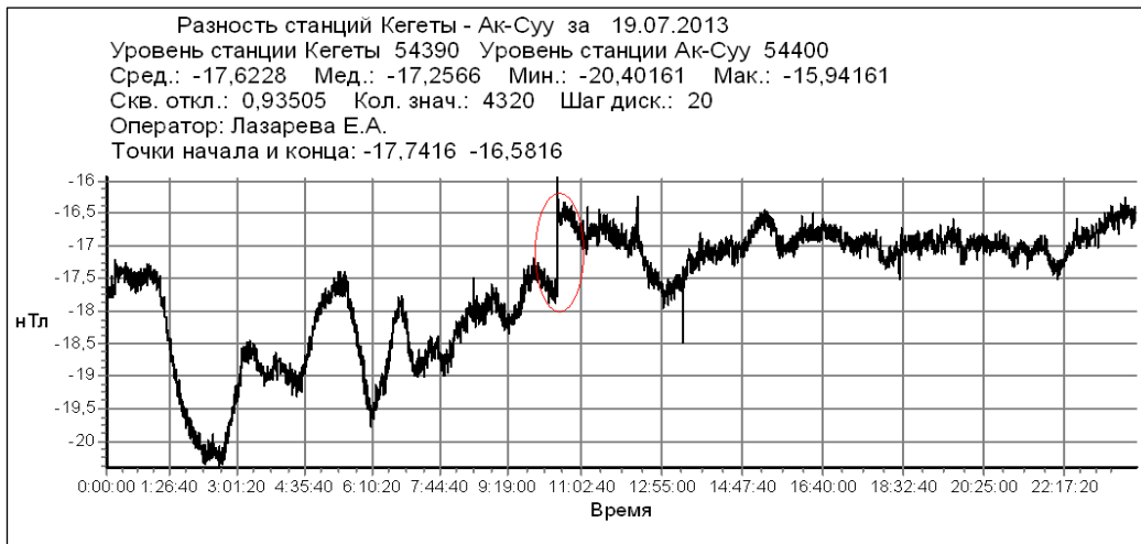
Рис.6. Магнитограмма со ступенчатым искажением
