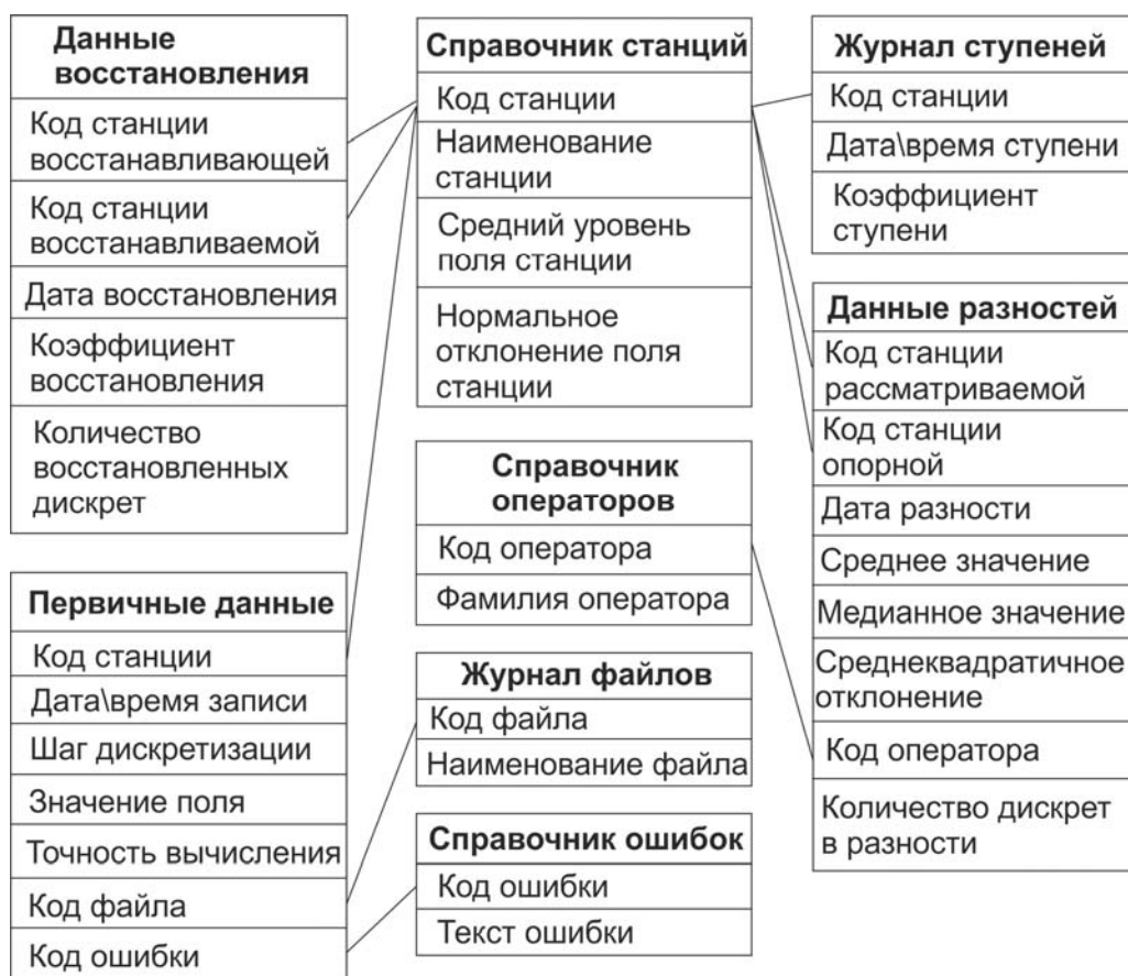
Рис. 3. Структура базы данных DataMAG .
