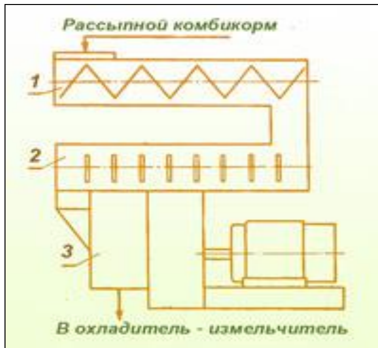
Рис. 3. Технологическая схема установки ДГ. Условные обозначения: 1 – питатель; 2 – смеситель; 3 – пресс-гранулятор.
