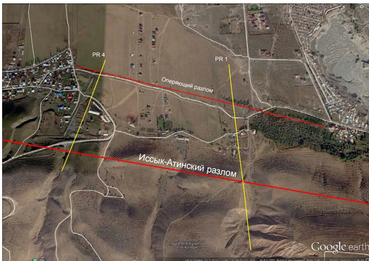
Рис. 4. Космический снимок с детальным расположением Иссык-Атинского разлома на южной окраине г. Бишкек.
