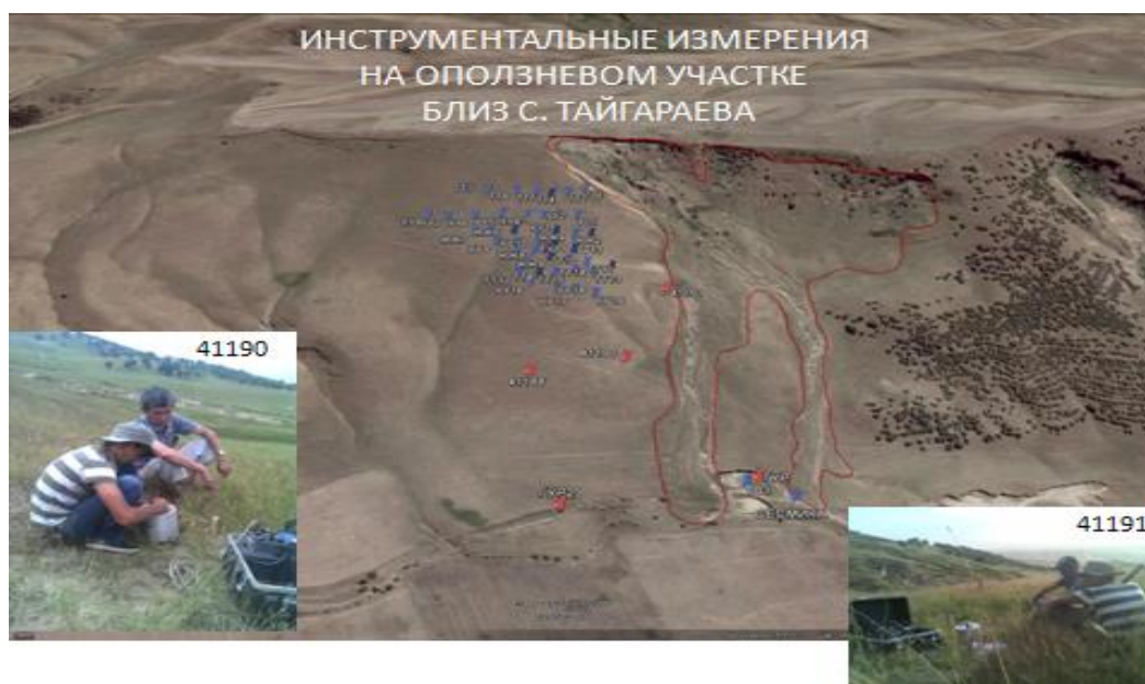
Рис. 4. Фотодокумент сейсмического зондирования с помощью метода микросейсм (сейсмических шумов) оползнеопасного склона вблизи с. Тайгараева.
