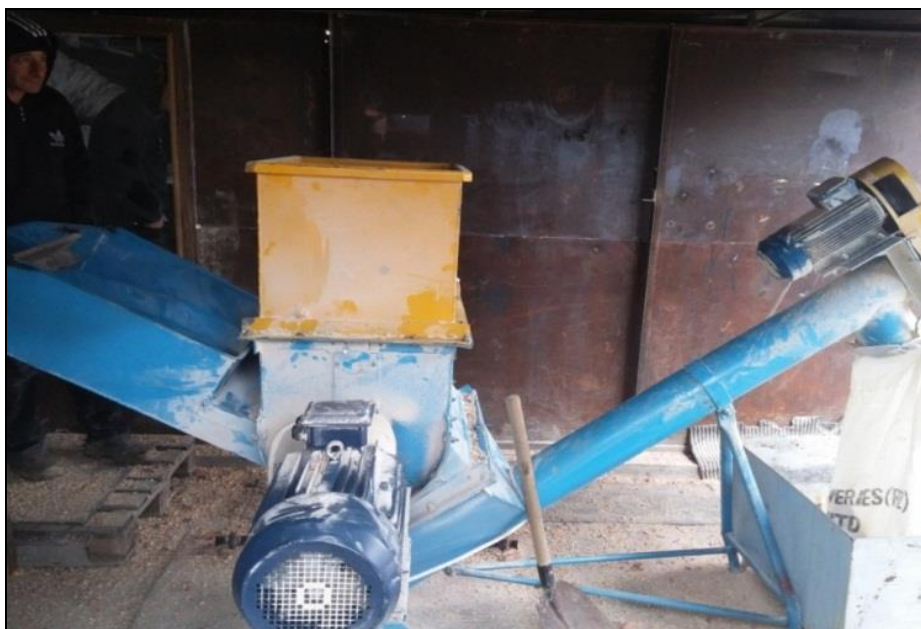
Рис. 1. Малогабаритный кормоприготовительный агрегат ДУ-11.
