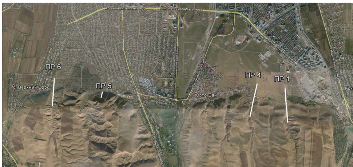
Рис. 1. Космоснимок с профилями магнитометрического зондирования Иссык-Атинского разлома в 2010 и 2015 годах.
