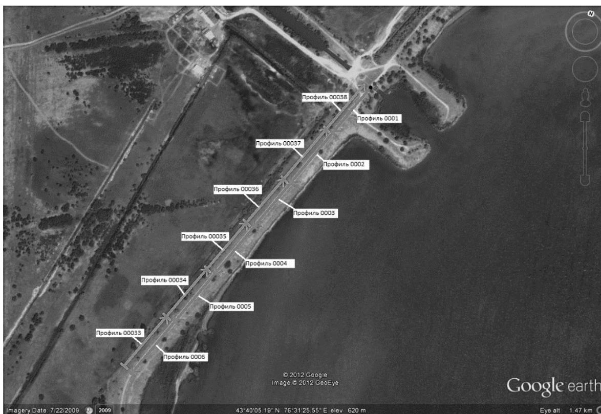
Рисунок 1 - Схема расположения геофизических профилей на 1-ой плотине накопителя сточных вод «Сорбулак»
