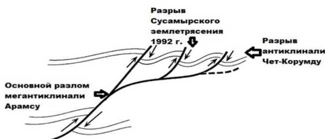
Рисунок 3 – Рисунок, объясняющий перераспределение смещений по главному разлому на глубине между несколькими вторичными плоскостями, достигающими поверхности, и положение разрывов, указанных в тексте [5]
