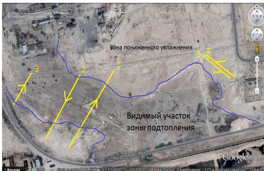
Рисунок 4 – Схема расположения георадарной съёмки и нумерация геофизических профилей на участке подтопления в районе ГПЗ
