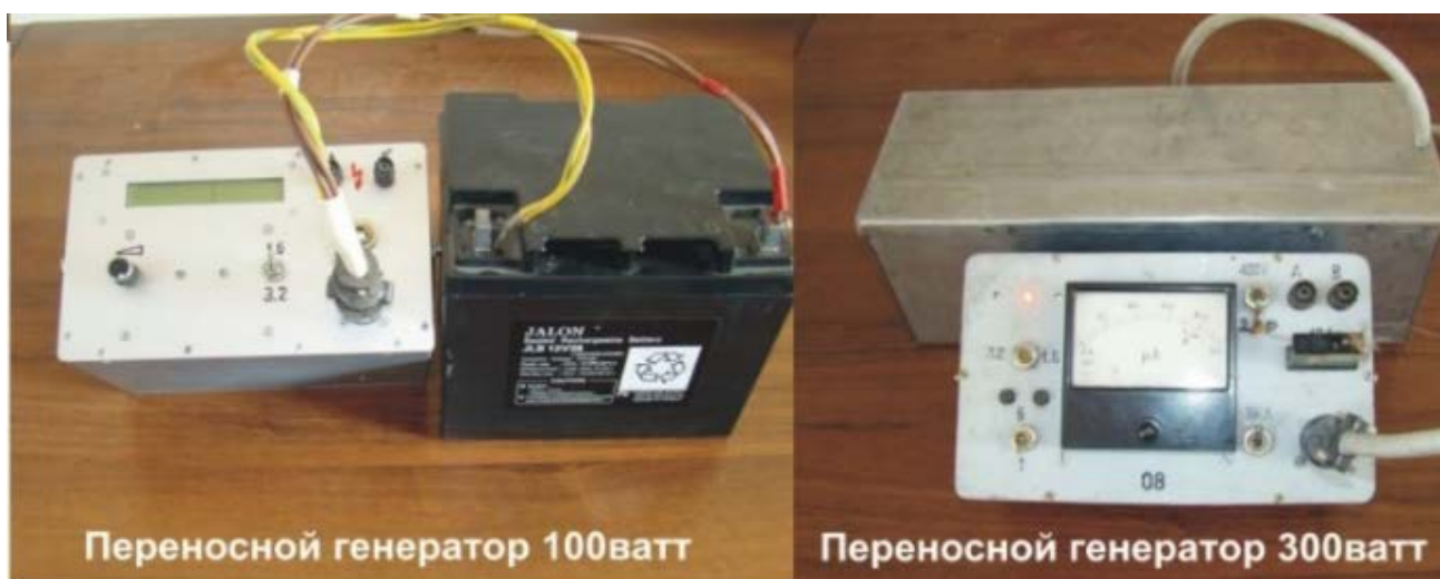
Рисунок 4 – Внешний вид генераторов тока оригинальной аппаратуры «Diapir-T».
