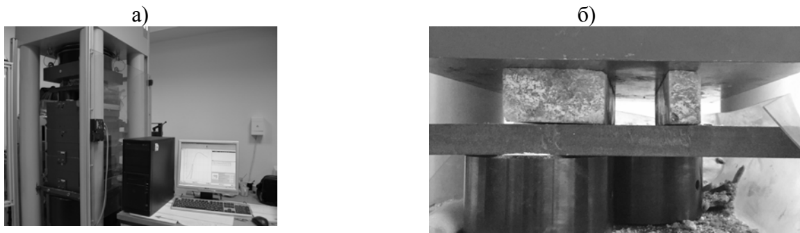
Рисунок 1 - Пример проведения испытаний на образцах различной геометрической конфигурации: а - пресс ToniNorm2041; б – сжатие образцов прямоугольной формы различной ширины
