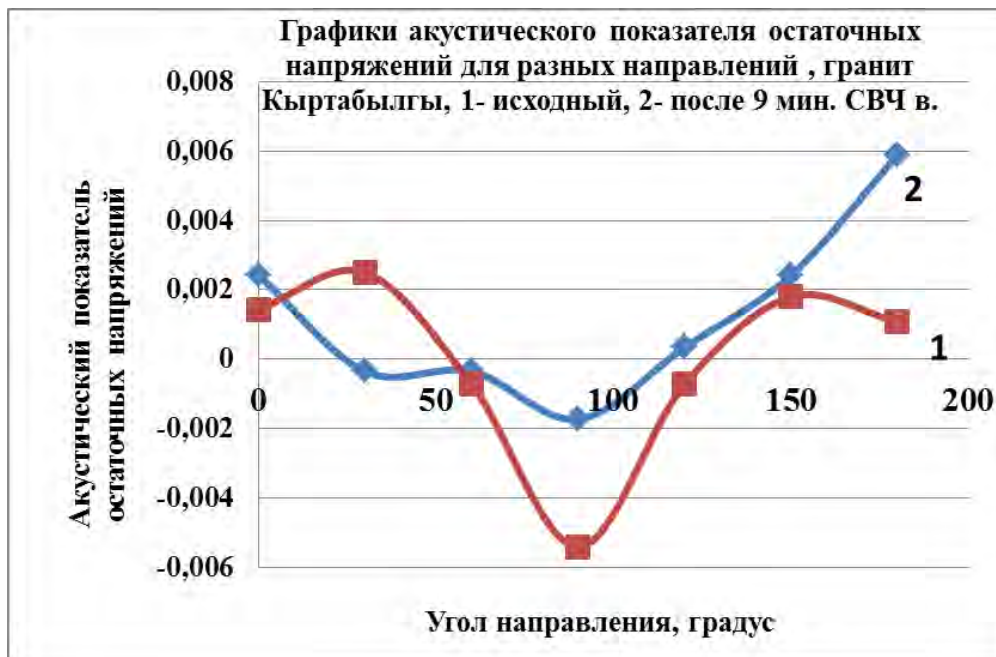
Рисунок 4 – Графики акустического показателя остаточных напряжений (гранит, Кыртабылгы, обр.6, 1-исходное состояние, 2- после воздействия СВЧ волнами 9 минут)
