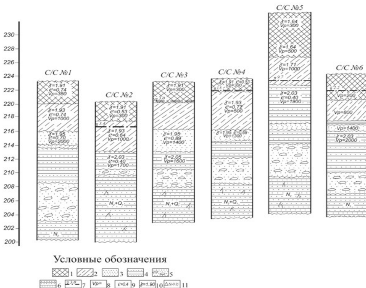
Рисунок 1 – Сейсмогеологическая колонка пунктов установки сейсмометрических станций на территории г. Бухара: где 1. Насыпные отложения; 2. Супеси и суглинки; 3. Пески мелкозернистые; 4. Переслаивающиеся толщи песчаников и глин; 5. Гравийно-галечниковые отложения; 6. Переслаивающиеся алевролиты и гравелиты; 7. Глубина залегания уровня грунтовых вод; 8. Скорость прохождения продольных волн (м/сек); 9. Коэффициент пористости; 10. Объёмная масса влажного грунта (г/см 3 ); 11. Пункт сейсмометрических наблюдений, в скобках приращение балльности. Скорости сейсмических волн могут быть использованы как прямой показатель при оценке сейсмической интенсивности
