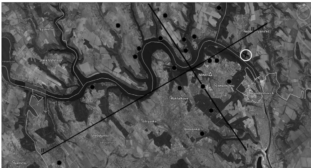
Рисунок 2 – Карта-схема (на базе карты Google) сейсмичности района Днестровской ГЭС за период 2014-2018 гг. Здесь: черные кружки – эпицентры землетрясений различной энергии; белый треугольник – сейсмическая станция Новоднестровск, белый круг – макросейсмический эпицентр землетрясения 22.10.2006 г. (показаны условные профиля I-I и II-II).
