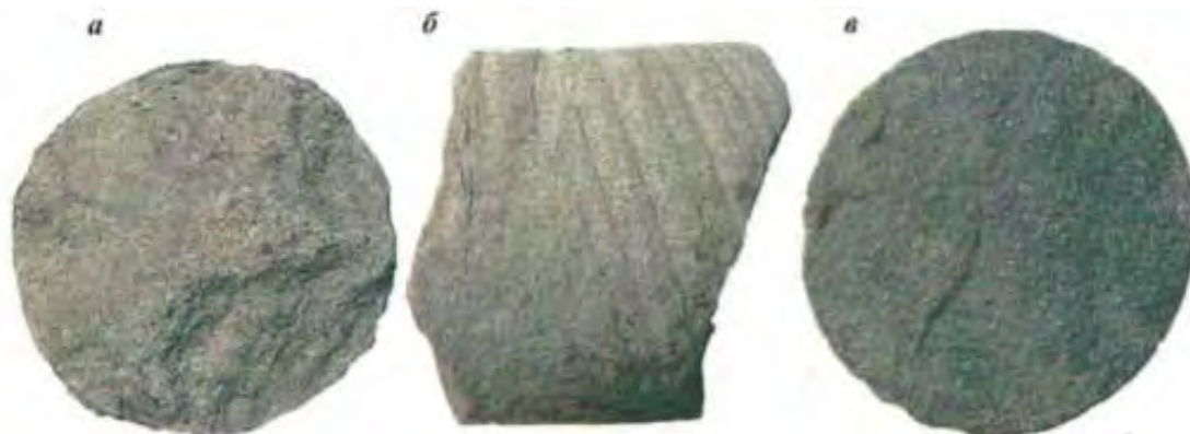
Рисунок 1 - Песчаник олигомиктовый светло-серый, сильно пористый (а), гравелит мелко-среднезернистый (б), песчаник гравийсодержащий (в). Интервал отбора керна 2390-2400 м, площадь Джел, скв. 2
