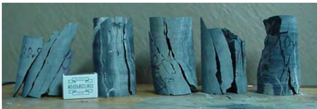
Рисунок 1 – Виды разрушения образцов вскрышных горных пород Кумторского месторождения при одноосном сжатии
