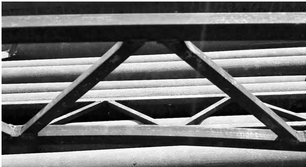
Рисунок 2 - Потеря устойчивости центральной панели
