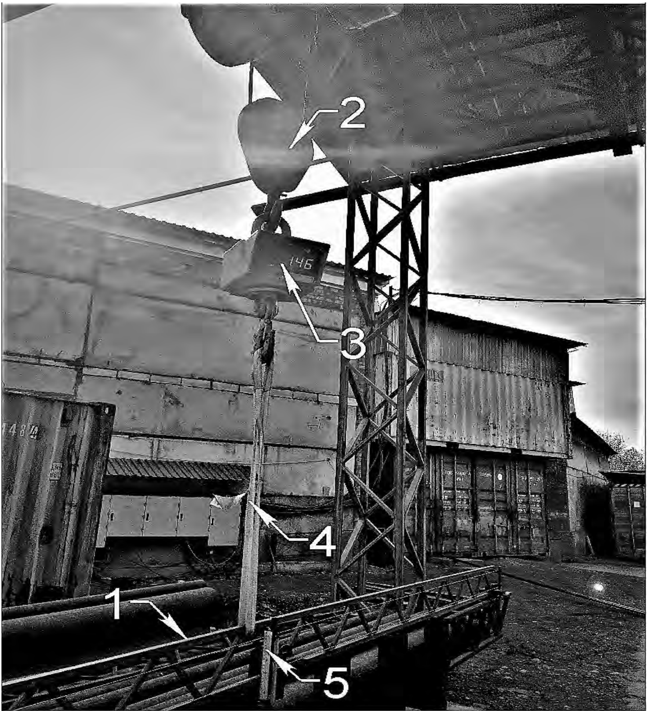
Рисунок 1 – Стендовое испытание 1-ФМ 200(5)1,5; 2-Подвесное грузоподъёмное устройство; 3-Подвесные весы; 4-Строп текстильный; 5-Линейка
