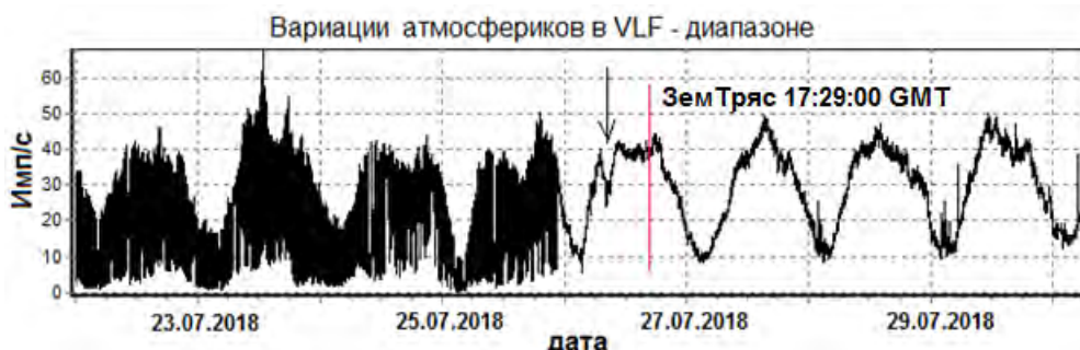
Рисунок 3 – Вариации потока атмосфериков до и после подключения фильтра нижних частот Чебышева седьмого порядка. Левая часть графика – запись без фильтра, правая - с подключенным фильтром Чебышева. Красной линией указано время землетрясения.
