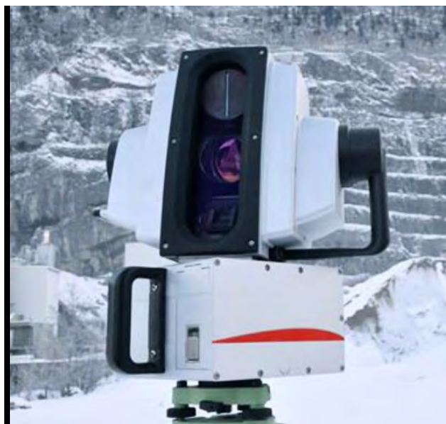
Рисунок 3 – Импульсная лазерная система сканера Leica HDS8800
