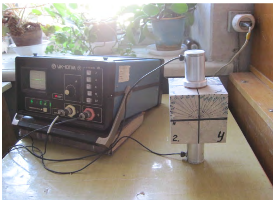
Рисунок 1 – Определение скорости поляризованной сдвиговой волны в разных направлениях кубического образца через 10 градус по X, Y, Z
