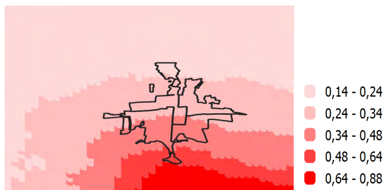
Рисунок 2 – Сценарий распределения пиковых ускорений грунта от землетрясения магнитудой 7,5, если очаг связан Шамши-Тундукским разломом
