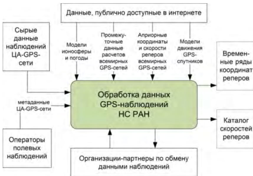
Рисунок 1 – Процесс обработки GPS-данных в ИС РАН (А.Н. Мансуров)
