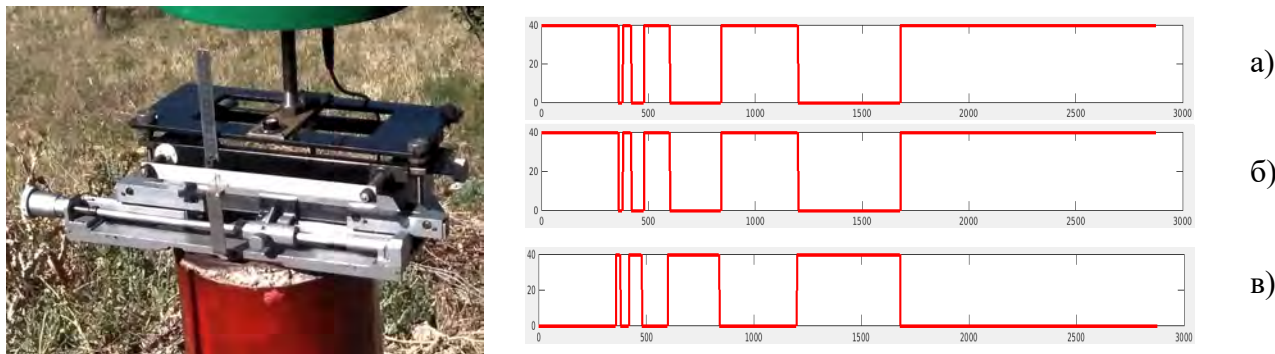
Рисунок 1 – Слева: 3D-корректор с установленной на него GPS антенной.
