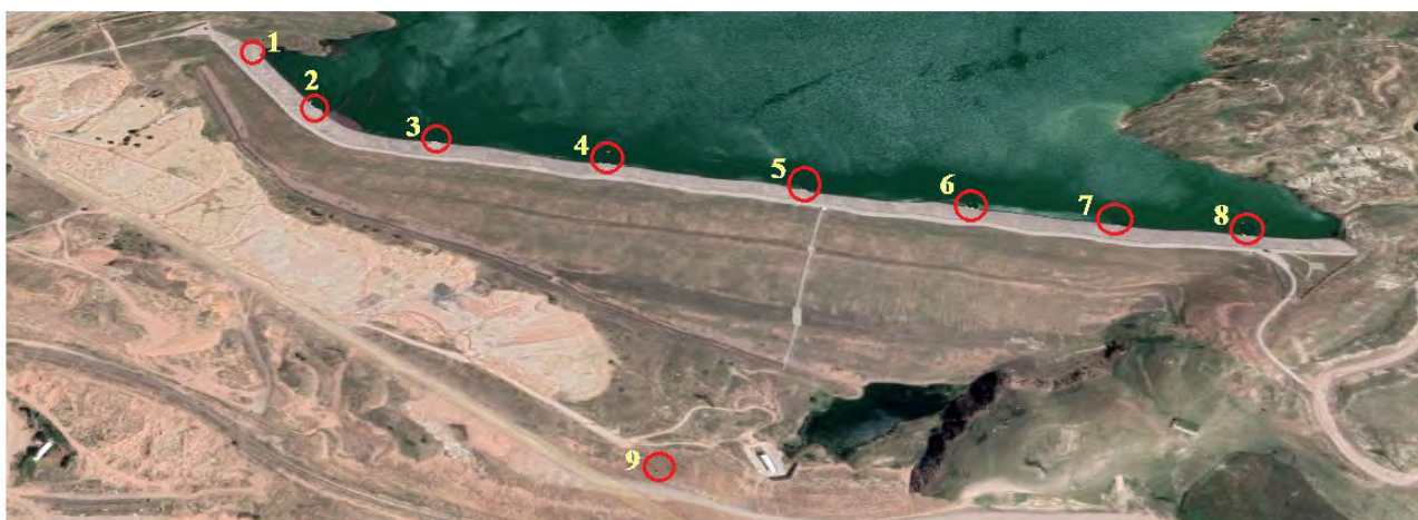
Рисунок 1 – Вид на водохранилище Ахангарон и точки, измеренные сейсмометром Guralp 6TDE на плотине (2022 год)
