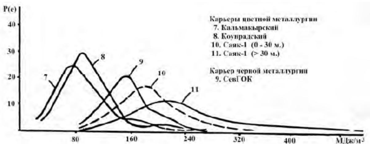
Рисунок 1 – Распределение энергоёмкости бурения для карьеров цветной металлургии
